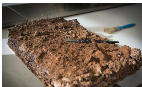
Fig. 2 – Monolito resultante de uno de los perfiles considerados tras la impregnación y tallado en el laboratorio.
