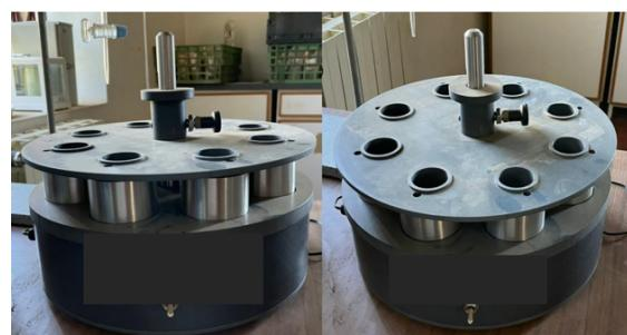
Fig. 2 – Equipamento de agitação e crivagem em húmido de amostras para determinação da Estabilidade da Agregação.
