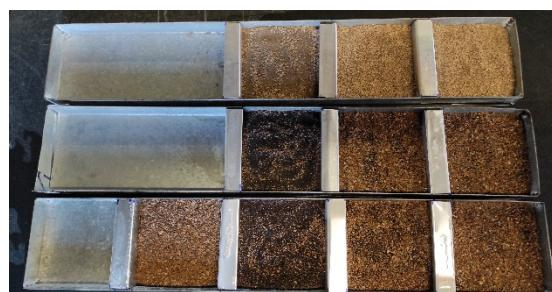
Fig. 1 – Dispositivo experimental para simulação de humedecimento e secagem das amostras.
