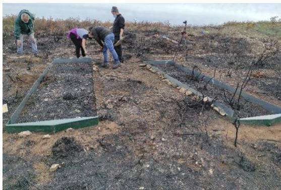
Fig. 2 – Instalação de parcelas de erosão
